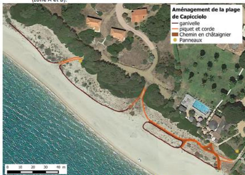
Figure 2 : Aménagement réalisé sur la plage de Capicciolo en 2008
